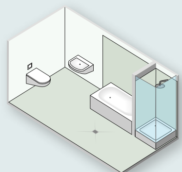
f Häusliches Bad mit Badewanne ohne Brause und mit Duschtasse mit Duschabtrennung: Bodenablauf im Raum.
